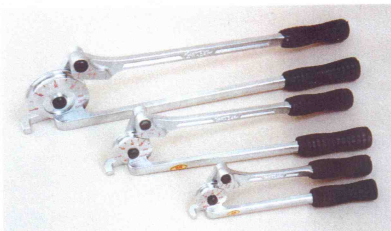
Инструменты для сгибания трубы. Оба указанных на рисунке инструмента подходят для сгибания твердой медной трубы.
