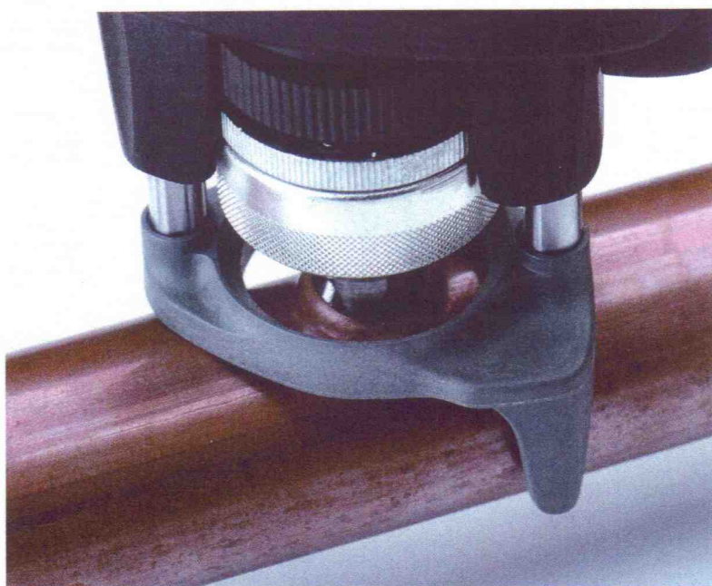
Поворачиваясь от регулировочного конуса, формовочные пальцы становятся в положение для формования воротника.
