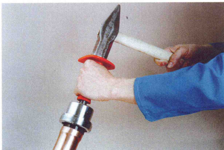
Для больших диаметров медной трубы используется ударная оправка.
